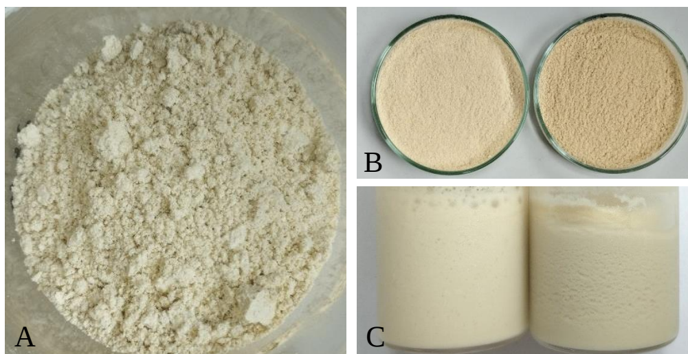
Abbildung 2: [A] vermahlener Hanfpesskuchen; [B] gefriergetrocknete Hanfproteinisolate, extrahiert bei pH 10,5 und einer Extraktionstemperatur von 20 °C (links) bzw. 40 °C (rechts); [C] thermisch induzierte Gele (20 %, w/w) aus Hanfproteinisolat (pH 10,5, 20 °C) bei pH 4 (links) bzw. pH 7 (rechts).
